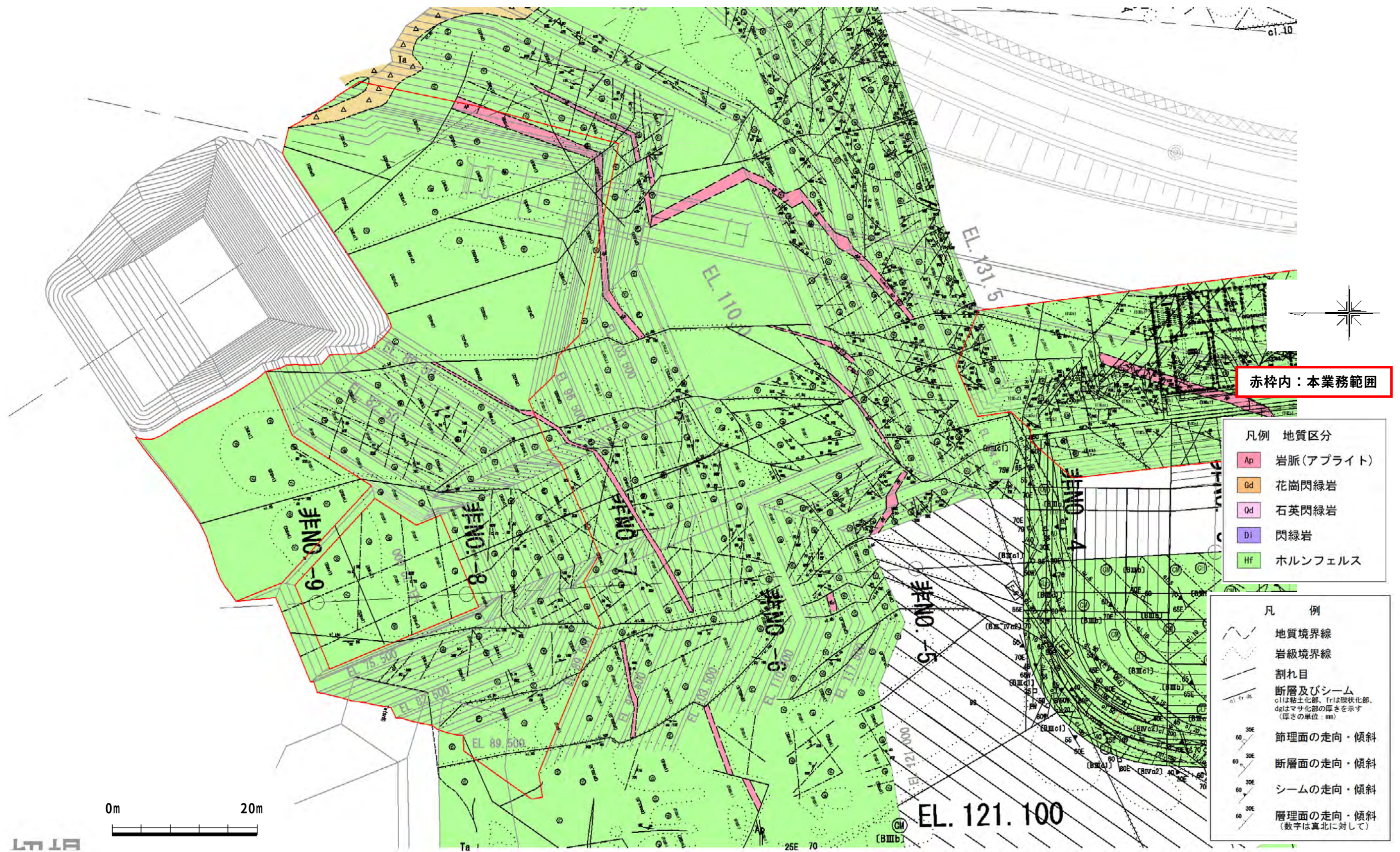
図- 3.1.21 岩盤スケッチ平面図 (地質区分)
