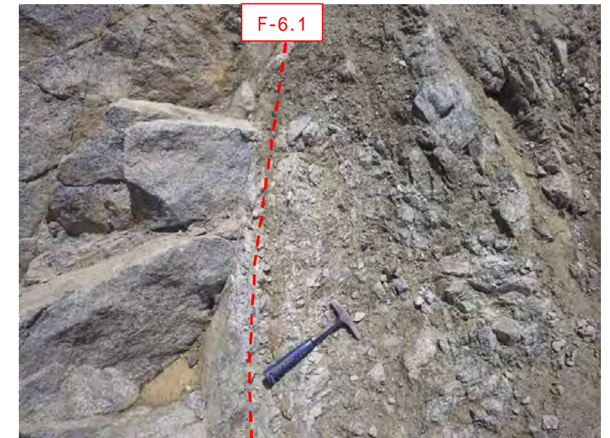
P.2 F-6.1 断層 幅 3cm 程度の灰色粘土部を伴う。 (確認日：平成 30 年 6 月 14 日)
