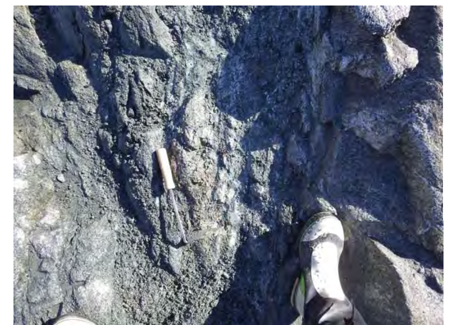
P.4 F-D 断層の近接写真 灰色粘土部は幅 5cm 程度である。
