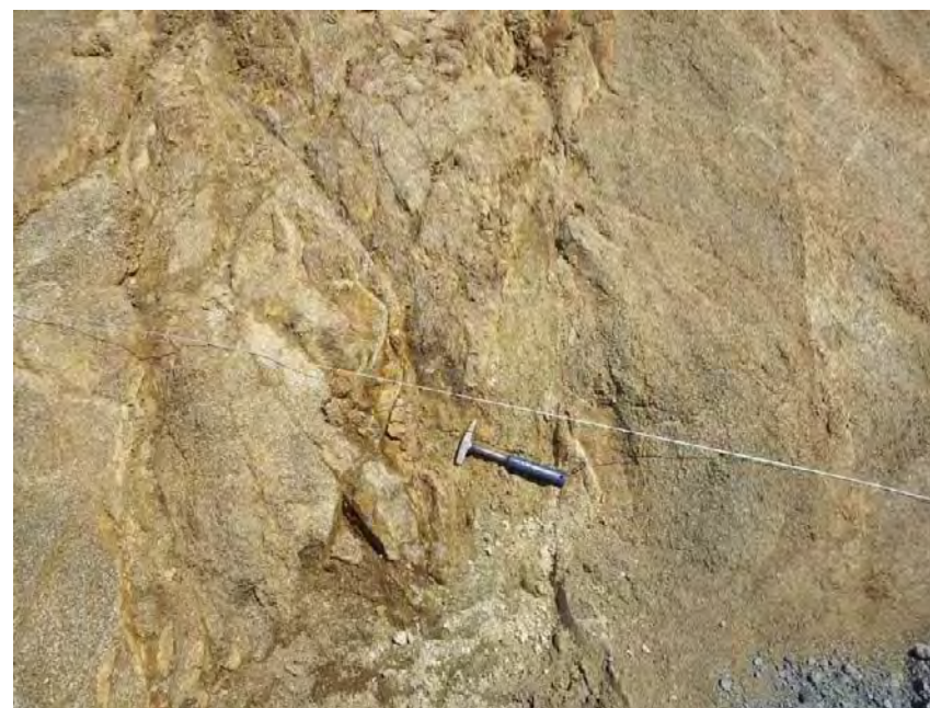
P.3 F-13 断層 灰色粘土部は幅 5cm 程度である。 (確認日：平成 30 年 9 月 19 日)
