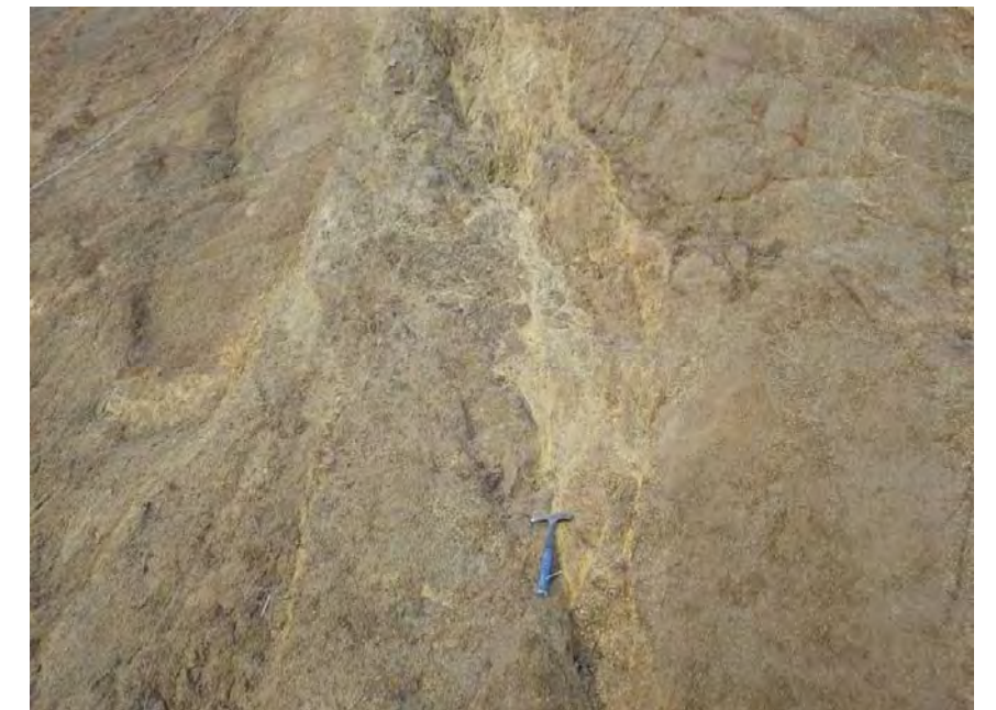
P.2 F-2 断層 灰色粘土部は幅 5 ~ 20cm 程度である。 (確認日：平成 30 年 10 月 9 日)
