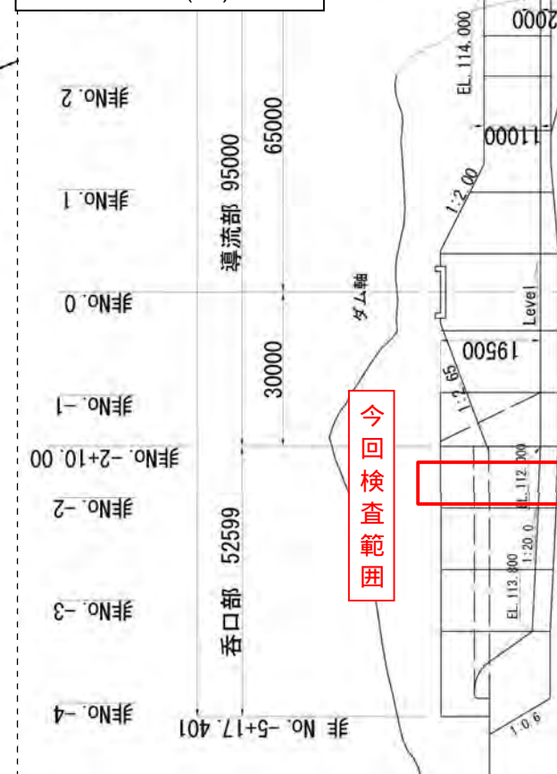
非常用洪水吐 流入部 縦断面図(CL)
