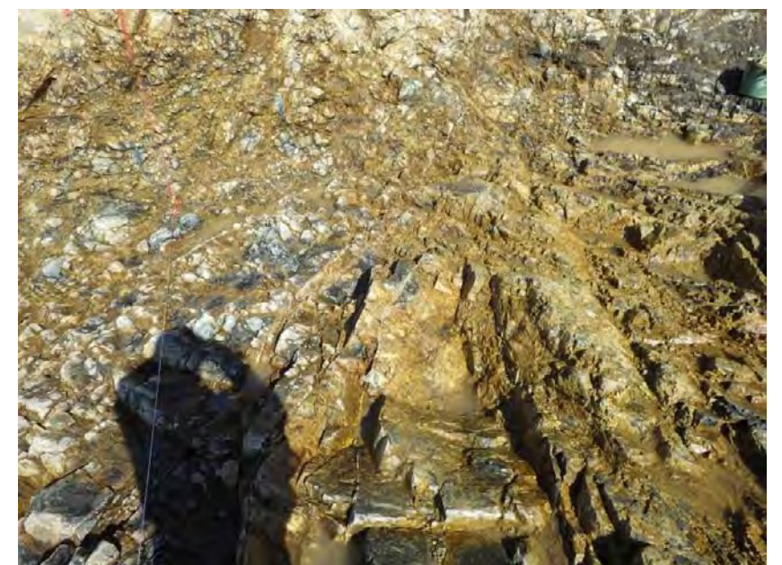
P.4 上流側の CLh 級岩盤 割れ目が発達し、割れ目面は褐色化する。 (確認日：平成 30 年 2 月 7 日)
