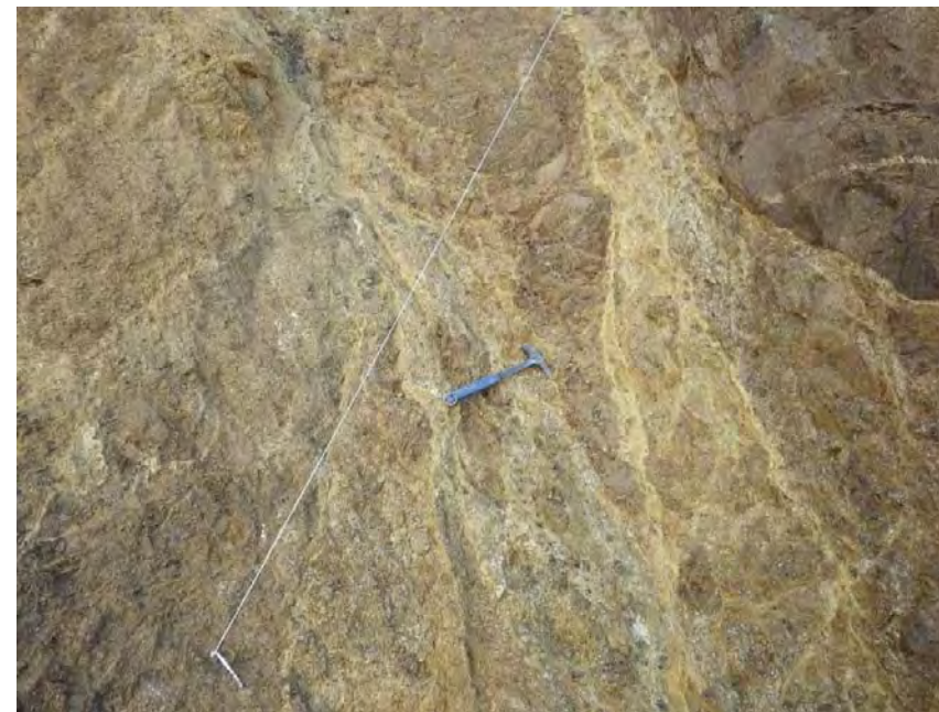
P.1 F-2 断層 灰色粘土部は幅 5cm ~ 20cm 程度であり、 派生断層が並行して分布する。 (確認日：平成 30 年 10 月 9 日)
