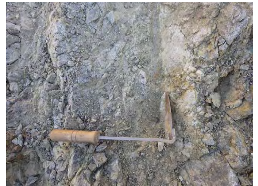
P.2 F-17 断層の近接写真 灰色粘土部は幅 10cm 程度である。 (確認日：平成 30 年 2 月 7 日)
