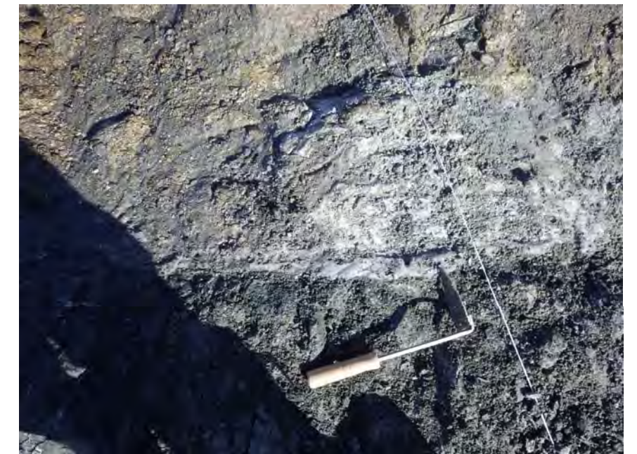
P.2 F-10 断層の近接写真 灰色粘土部は幅 20cm 程度である。
