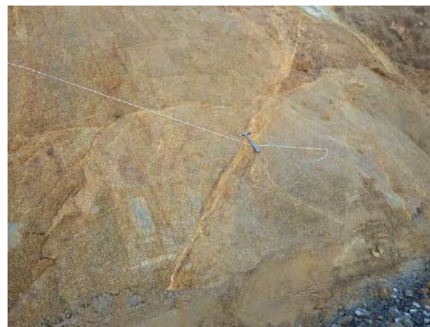
P.3 F-13 断層 灰色粘土部は幅 5cm ~ 10cm 程度である。 (確認日：平成 30 年 10 月 9 日)
