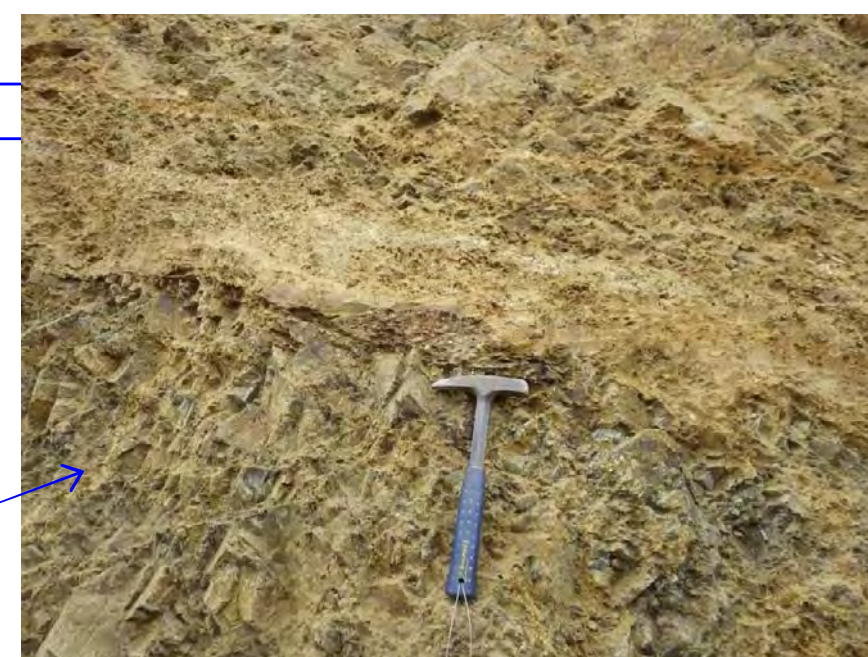
P.5 F-6 断層 幅 20cm 程度の灰色粘土部を伴う。
