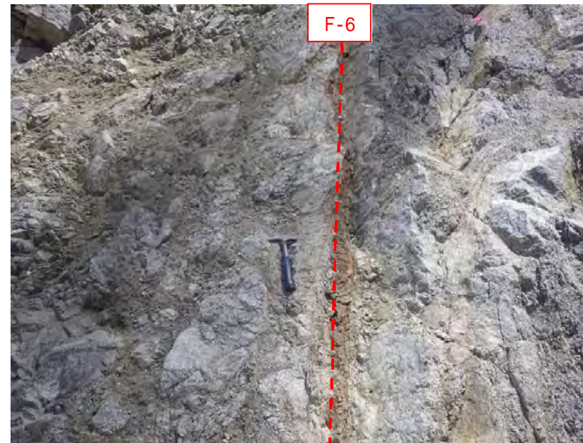
P.1 F-6 断層 幅 10cm 程度の灰色粘土部を伴う。 (確認日：平成 30 年 6 月 14 日)
