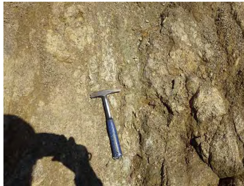
P.1 F-2 断層 灰色粘土部は幅 10cm ~ 30cm 程度である。 (確認日：平成 30 年 9 月 19 日)
