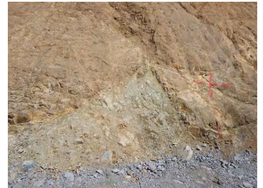
P.2 F-2 断層 灰色粘土部は幅 10 ~ 20cm 程度である。 河床部で分岐した派生断層と合流して 1 条になる。 (確認日：平成 30 年 9 月 19 日)
