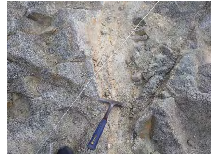
P.2 F-17 断層の近接写真 灰色粘土部は幅 2cm ~ 3cm 程度である。 (確認日: 平成 30 年 5 月 29 日)
