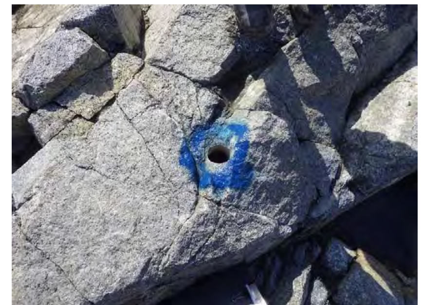
P.3 B-7 孔 深さ 1.6m 程度で土砂により孔詰まりしている。 (確認日：平成 30 年 10 月 24 日)
