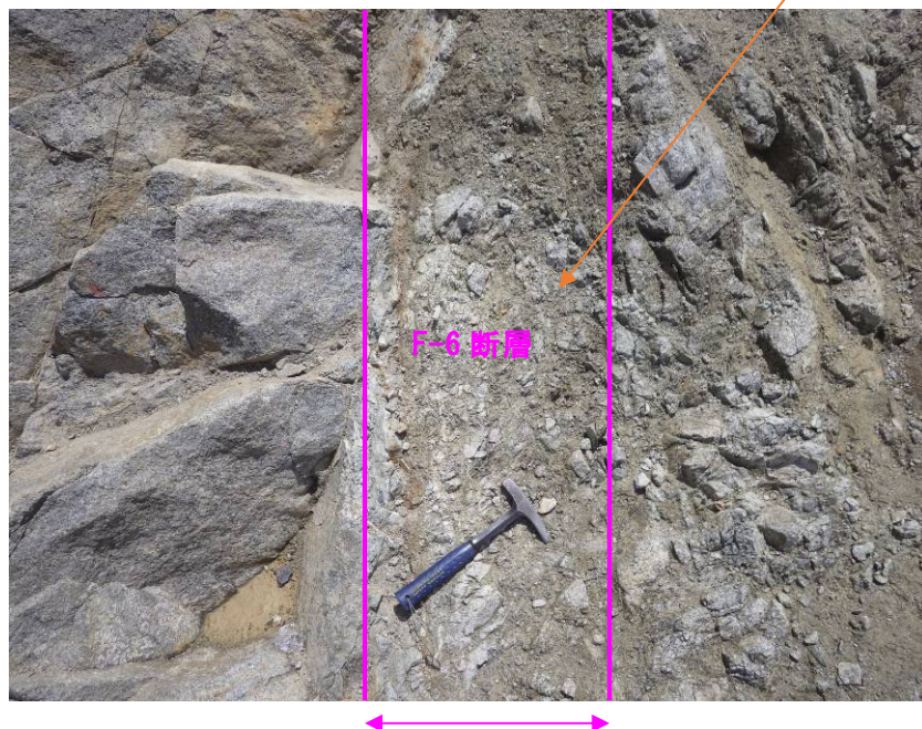
図- 6.1.11 F-6 断層の分布と安全側のモデル設定状況
