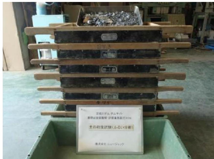
写真- 8.2.1 土の粒度試験（分級作業）(1)
