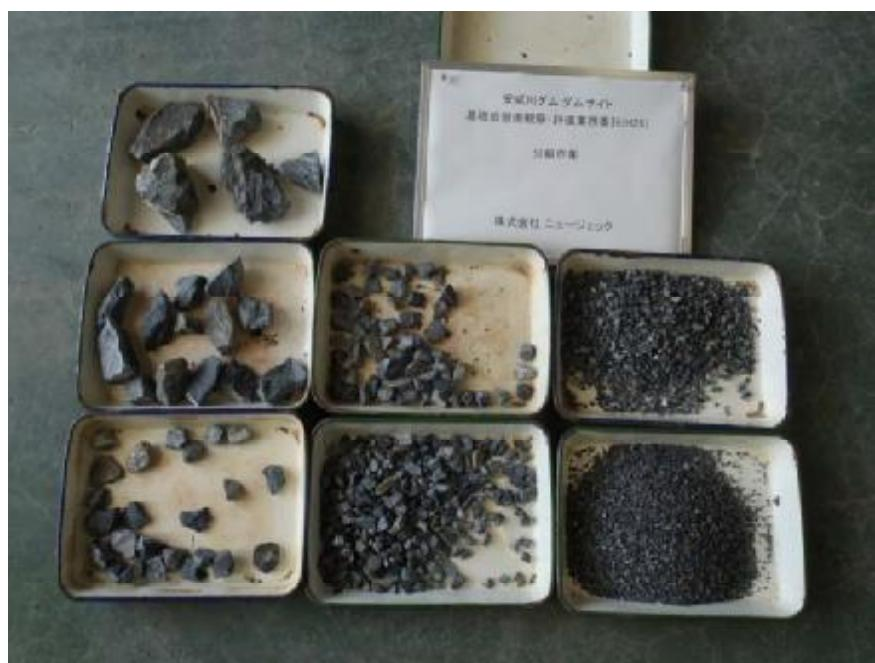
写真- 8.2.2 土の粒度試験（分級作業）(2)
