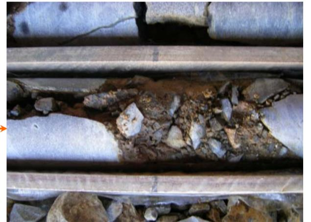
変質および風化により割れ目沿いが土砂化する。角礫部は風化せず残る。
