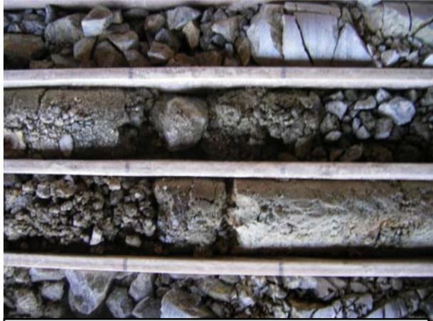
破碎帯。灰褐色礫混じり粘土。
