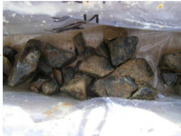
標準貫入試験の試料は礫のみ残る。
