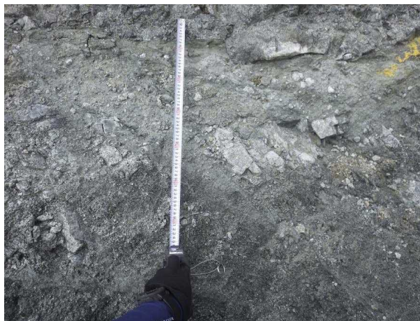
P. 3 F-12 断層 幅 50cm 程度の D 級岩盤が分布する。
