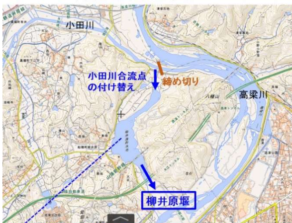
柳井原貯水池 湛水面積 100ha 貯水容量 約340万 m^3 目的:水道用水の供給等
